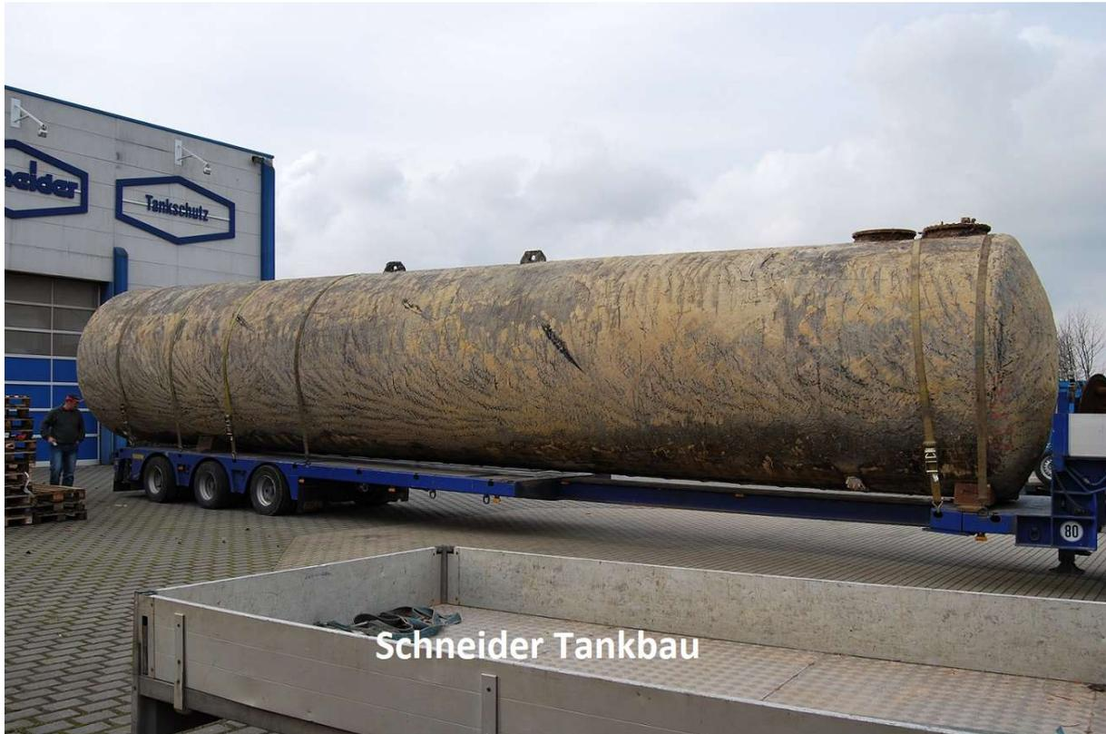
zur Lagerung von Regen- & Brauchwasser, Löschwasser, etc. Maße: D = 2,90 m - L = ca. 15,80 m
